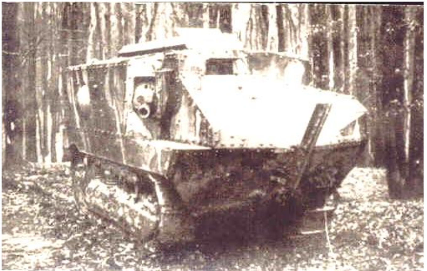
En essai de franchissement de tranchées étroites, le char Schneider N° 1.
